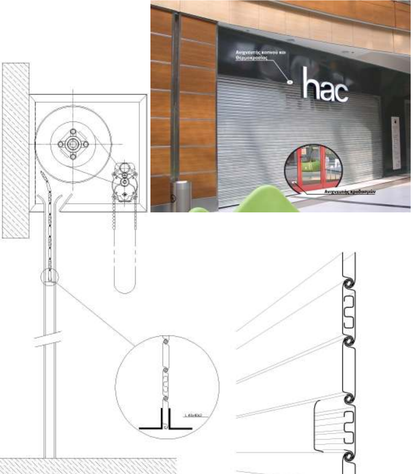
ΑΝΤΙΒΑΝΔΑΛΙΣΤΙΚΟ & ΠΥΡΑΝΤΟΧΟ ΡΟΛΟ (ΚΑΘΕΤΗ ΤΟΜΗ)
